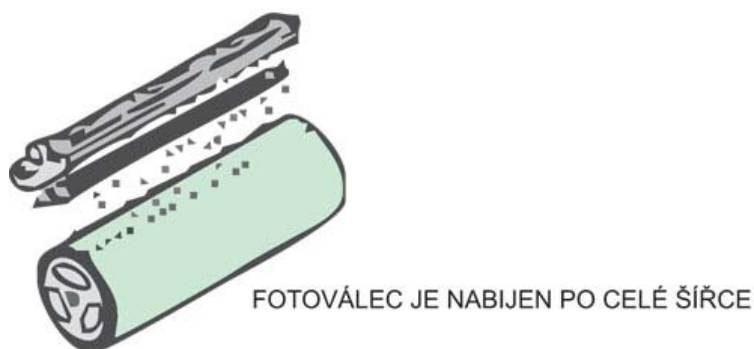
Obrázek 79 Způsob nabíjení válce
