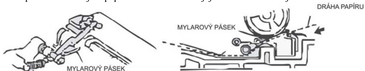
Obrázek 36 Separátor u optického válce
