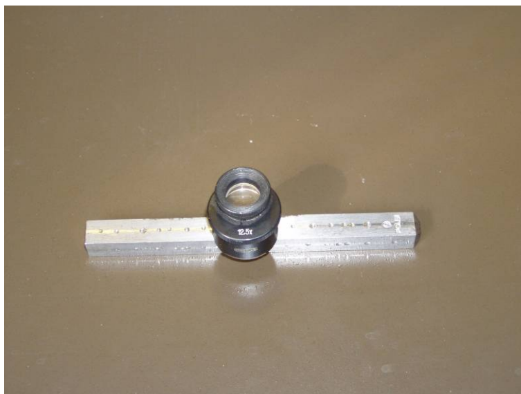
Obr. 27 – měření průměru otisku
