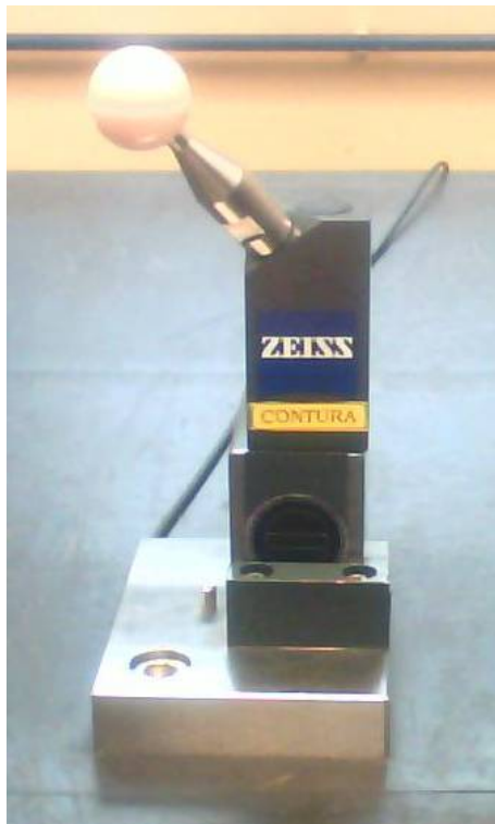
Obr. 63 – kalibrační normál na kovové desce
