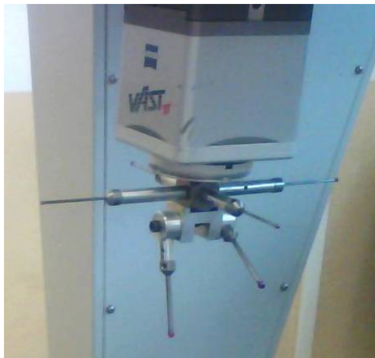
Obr. 61 – detail talířku se systémem tvořící 6 snímačů
