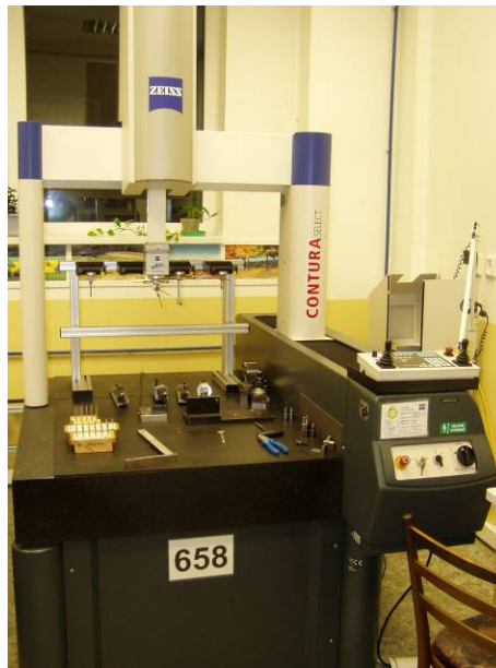
Obr. 8 – portálové délkové měřidlo od firmy Zeiss
