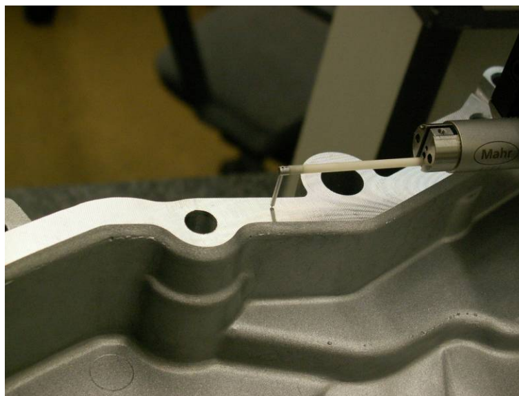
Obr. 44 – drsnoměr měřící drsnost dělicí roviny
