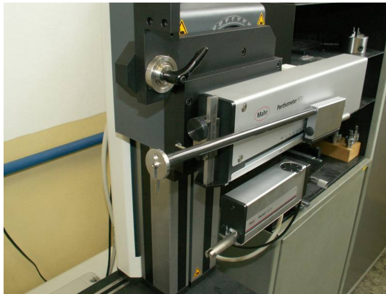
Obr. 49 – kalibrace měřící síly
