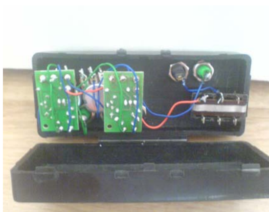
obr.4.2.12. – pohled do vnitřku regulátoru
