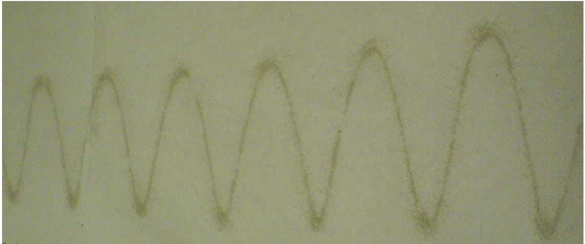
obr. 4.3.9. – pozorovaný záznam – s viditeľným útlumem
