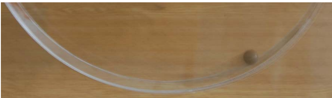
obr. 4.4.7. – U-dráha – detail-kulička v pohybu
