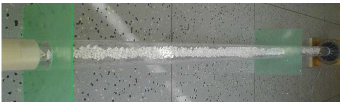
obr. 4.1.8. - Kundtova trubice s polystyrenem – s detailom zakončovaciho pístu
