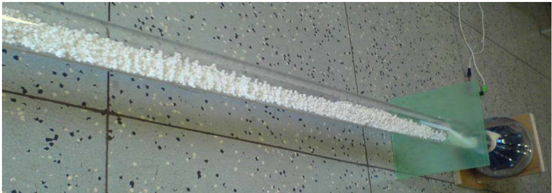
obr. 4.1.7. - Kundtova trubice s polystyrenem – s viditeľnou kmitnou
