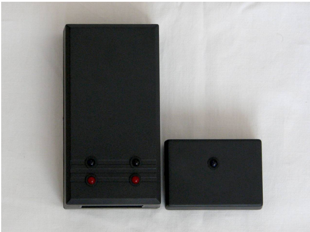
Obr. 3.5 – Celkový pohled na infra závoru
