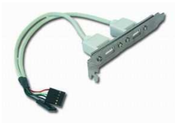
Obrázek 3.1 : Vyvedené USB konektory do záslepky [9]
