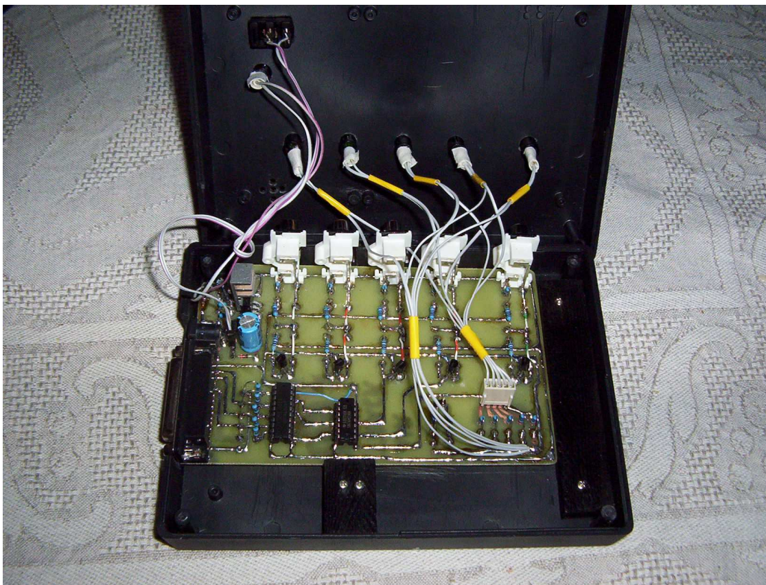
Obrázek 5.5 Finální podoba DPS osazená v krabičce
