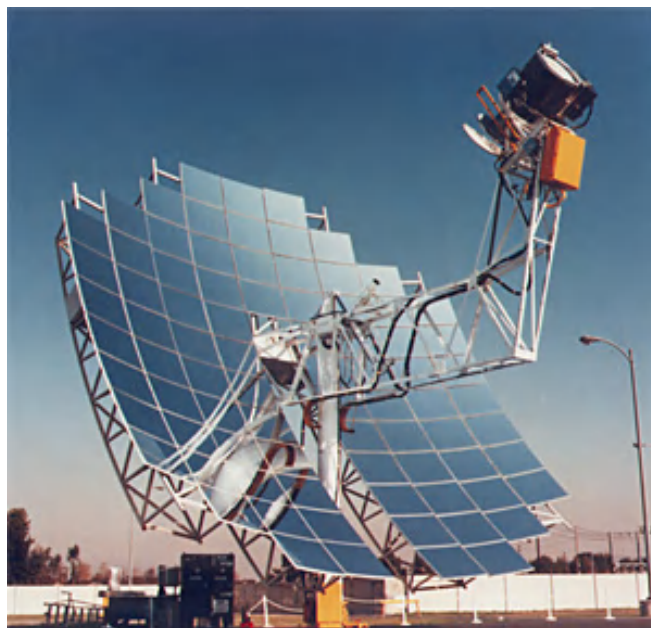
obr. 1.3.12 Solární jednotka SES 25 kW ( www.engine.stirling.cz )
