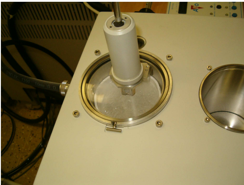
Obrázek 7.6: VTD nasazené na slushing station – probíhá čerpání komory a vzorek je vytažen nad hladinu dusíku:
