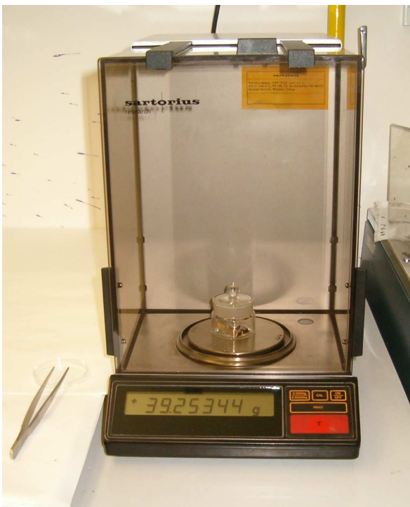
Obrázek 7.8: vážení testovací pomůcky ve váženice na laboratorních vahách:
