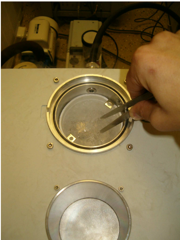
Obrázek 7.6: VTD nasazené na slushing station – probíhá čerpání komory a vzorek je vytažen nad hladinu dusíku:
