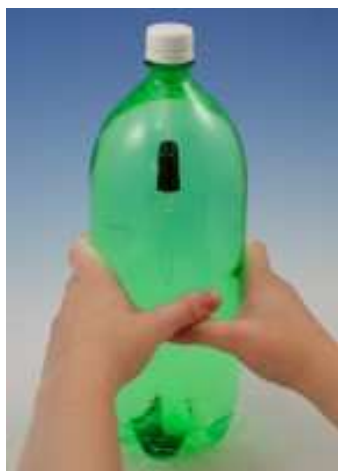
Obr. 6.2.10: Improvizovaný karteziánek z kapátka v plastové lahvi
