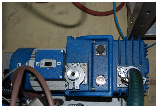
Obr. č. 19: Olejová rotační vývěva VRO 15-20
