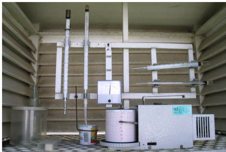
Obr. 6.2-2 Rozmístění přístrojů v meteorologické budce, ČHMÚ České Budějovice
