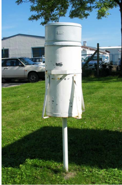
Obr. 6.8.1-1 Srážkoměr (ombrometr), ČHMÚ České Budějovice
