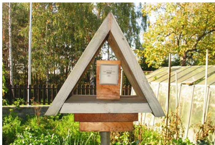
Obr. 7.2-1 Bezdrátové čidlo TX2 v budce
