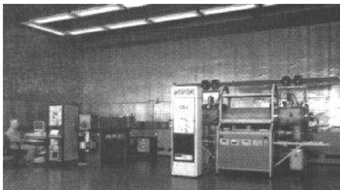
Obr. 16 Atomové hodiny CS1 a CS2 v bývalém SRN
