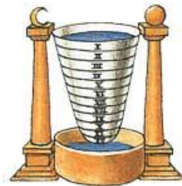
Obr. 6 Vodní hodiny trychtýřovitého tvaru
