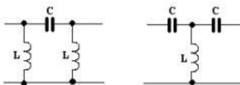
Obr. 14. Příklad zapojení hornofrekvenční propusti tvaru \Pi a T [7]
