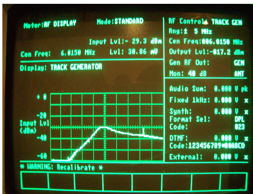
Obr. 39. Změřený útlum laděného LC obvodu z obr. 36
