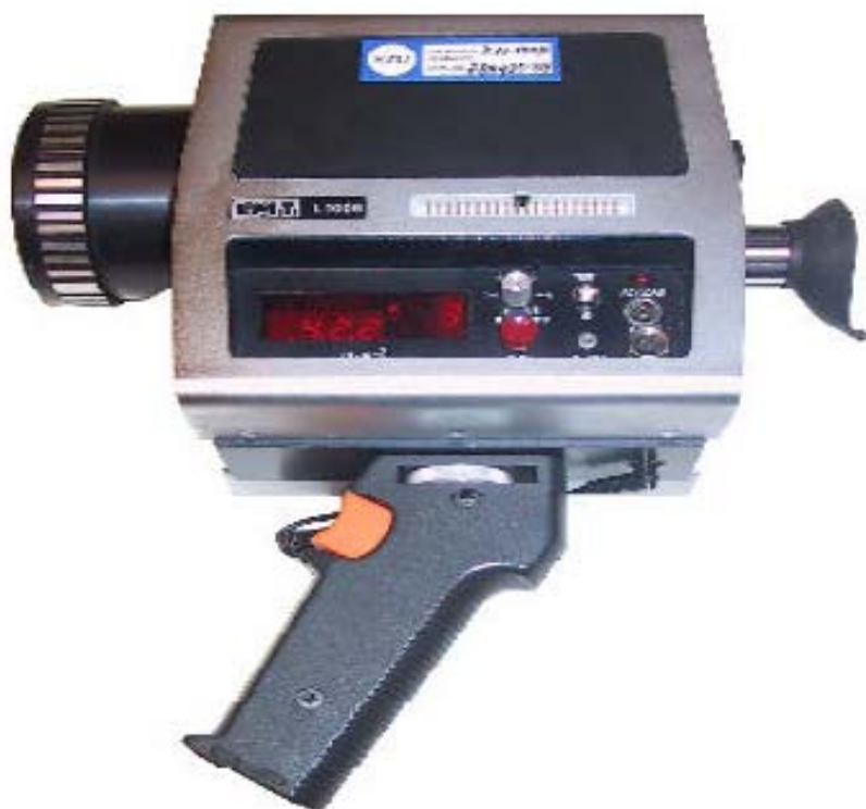
Obr. 5.12.3 jasoměr série L 1009 německé firmy Lichtmesstechik Berlin [88]
