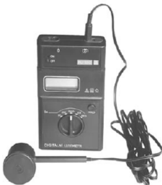
Obr.5.11.1 Digitální provozní luxmetr typu PU 550 Metra Blansko [68]
