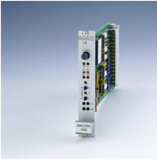
4411-8: Vyhodnocovací deska počítače náprav
