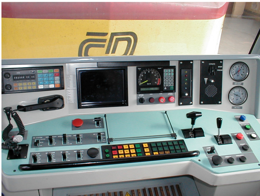
11-4: Řídicí vůz řady 971, pohled na řídicí pult s monitorem palubního počítače (foto autor)
