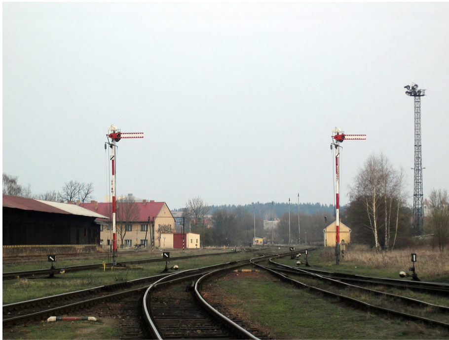
11-1: České Velenice, mechanická návěstidla v poloze Stůj na odjezdových kolejích směr Gmünd n/Ö (foto autor)
