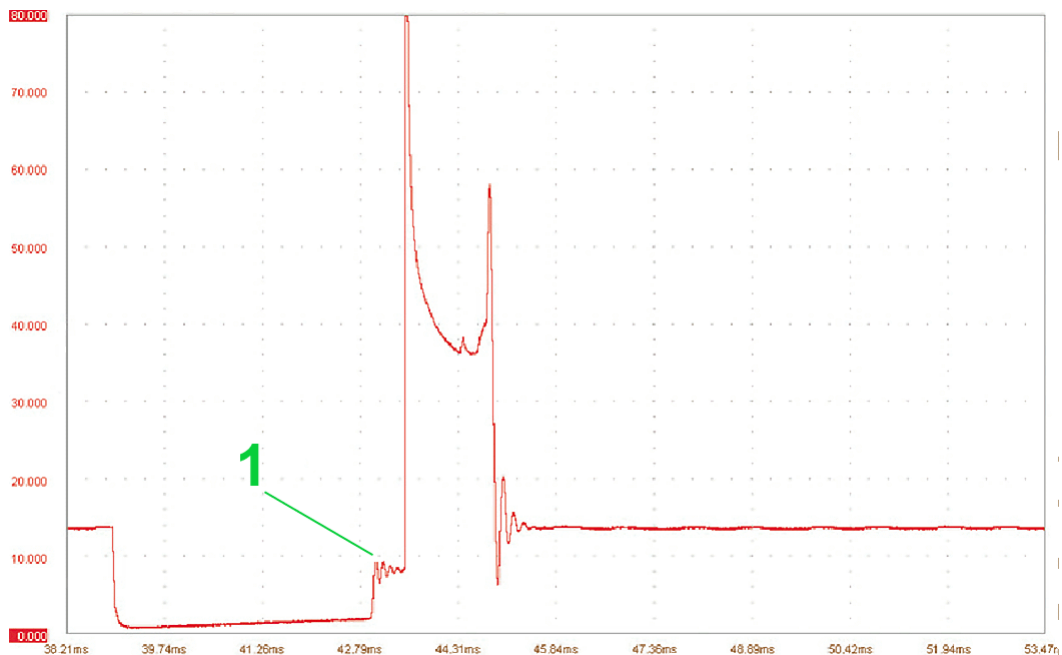
Obrázek 162 Průběh signálu zapalování na primárním vinutí
