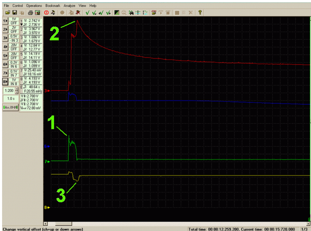
Obrázek 158 Test skokové lambda sondy – studený start a volnoběh
