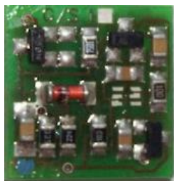
Obr. 11 Zpoždovací člen pro typ G
