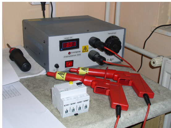
Obr. 29 a 30 Zdroj reziduálního proudu a vysokého napětí
