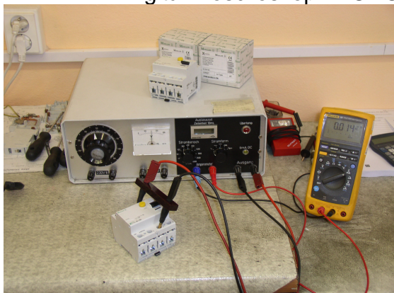
Obr. 29 a 30 Zdroj reziduálního proudu a vysokého napětí
