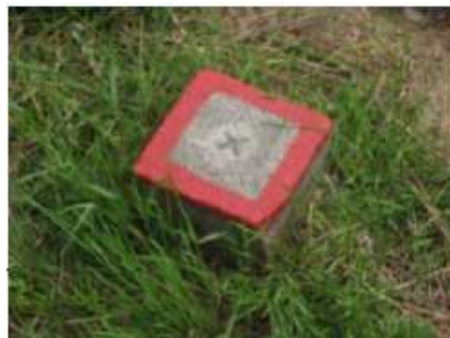
Obr. 2: Stabilizace geodetického bodu
