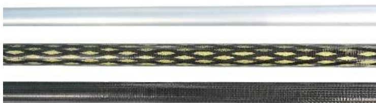
Obrázek 44. Duralová žerd', uhlíková měkká žerd', uhlíková tvrdá žerd' (www.profiplast.cz)
