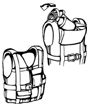
Obrázek 11. Plovací vesta s kapsou pro házecí pytlík (Kračmar,2000)
