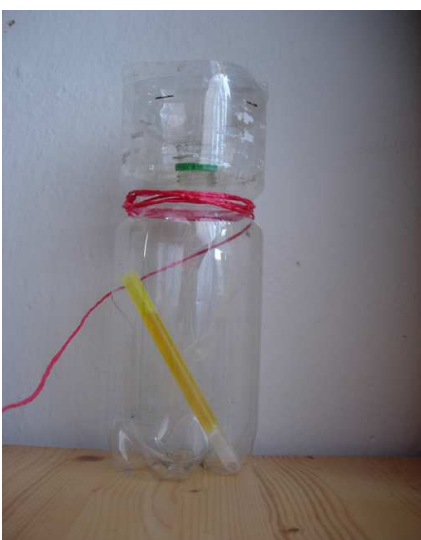
Obr. 3 Ukázka světelné pasti : PET- lahev s růžovým studeným světlem
