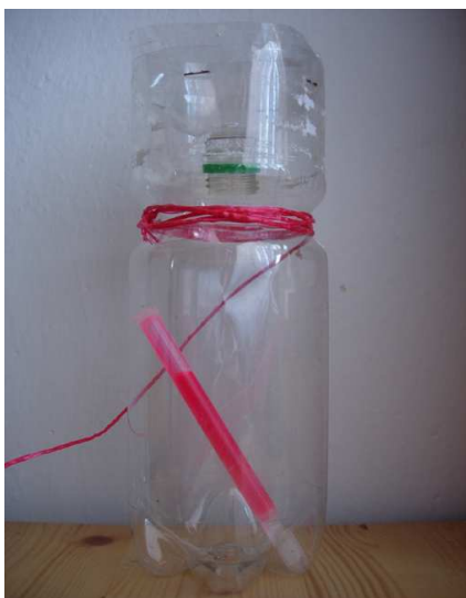
Obr. 3 Ukázka světelné pasti : PET- lahev s růžovým studeným světlem
