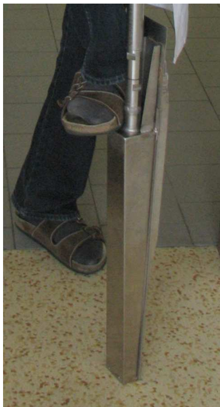
Obr.13a: Sonda na odběr sedimentu (foto J.Bastl), 13b:Sonda při odběru (foto Vymazal)
