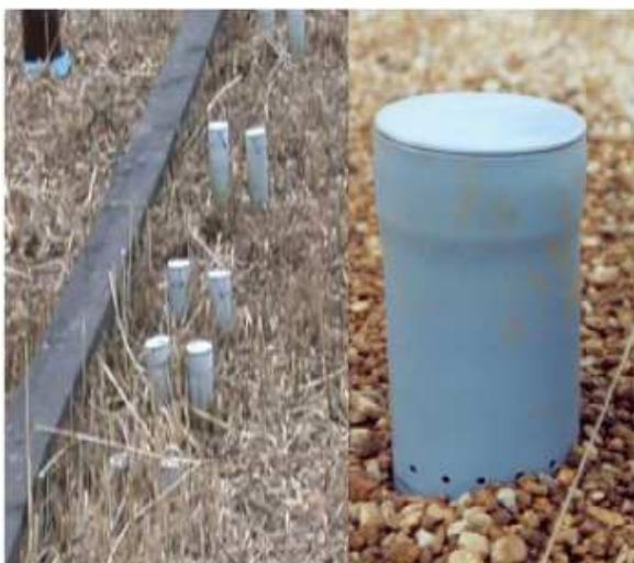
Obr. Č .15: Vzorkovací trubka pro odběr vody na stanovení forem železa (Štěpánek, 2007)
