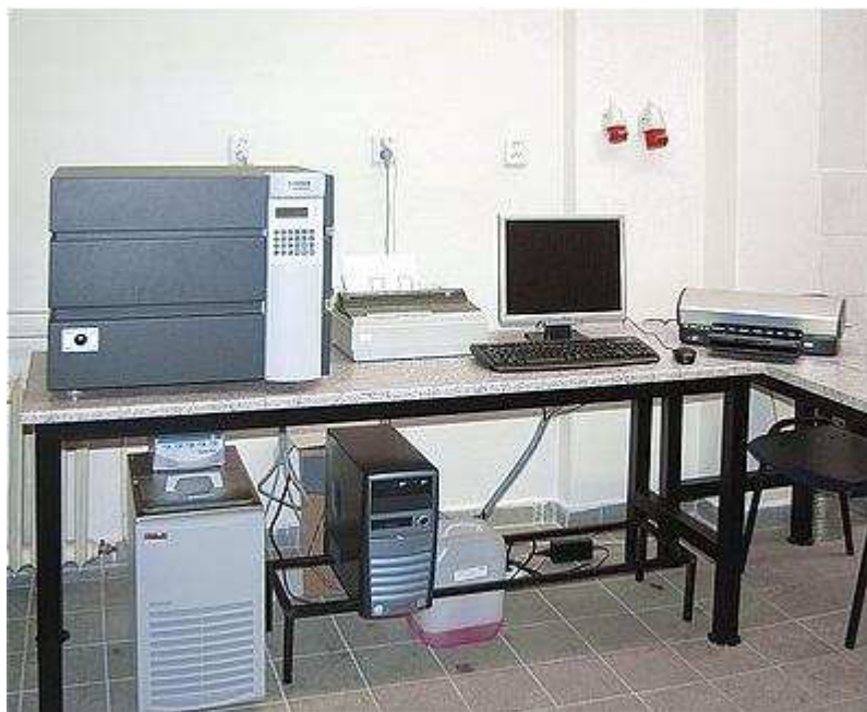
Obr. 4.11 Úplná sestava měřicího zařízení HFM 436/3/1E Lambda ® s externím programovým vybavením Q-Lab [16]
