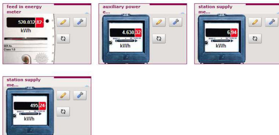
Obr. č. 14 Ukázka grafického zobrazení odečítaných hodnot z měřících hodin osazených ve fotovoltaické elektrárně v software SMA ® , převzato z [18].
