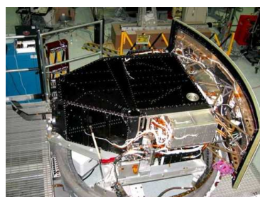
Obr. č. 29 – Širokoúhlá a planetární kamera WFC3
