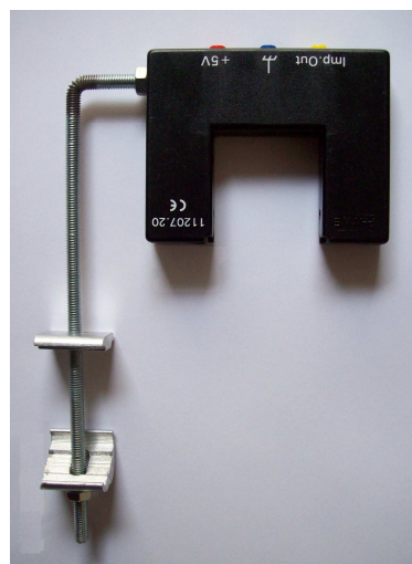
Obr. č. 2.2.3 Detail optické závory a držáku
