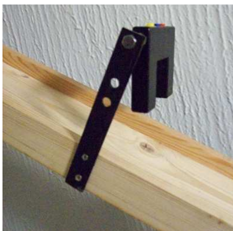
Obr.č. 3.4.1 Nové upevnění optických závor
