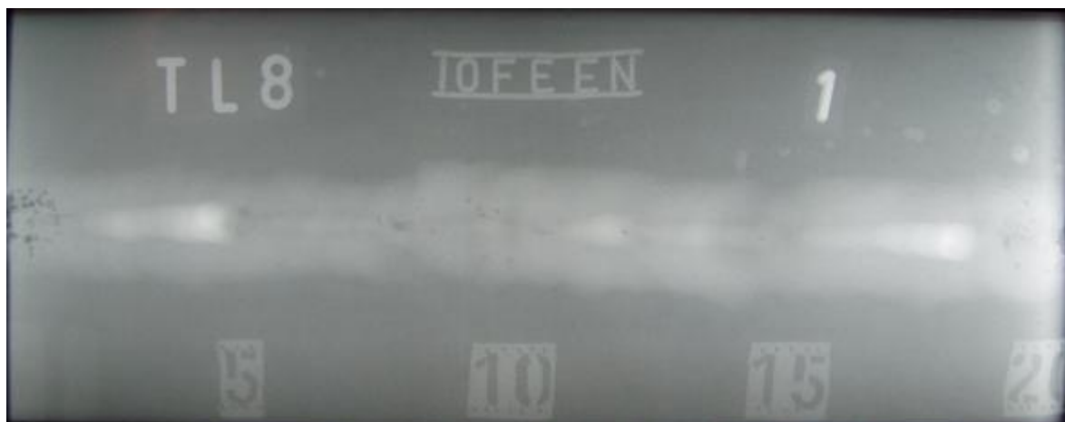
Obr. č. 21 - Ir 192 snímek - vzorek
