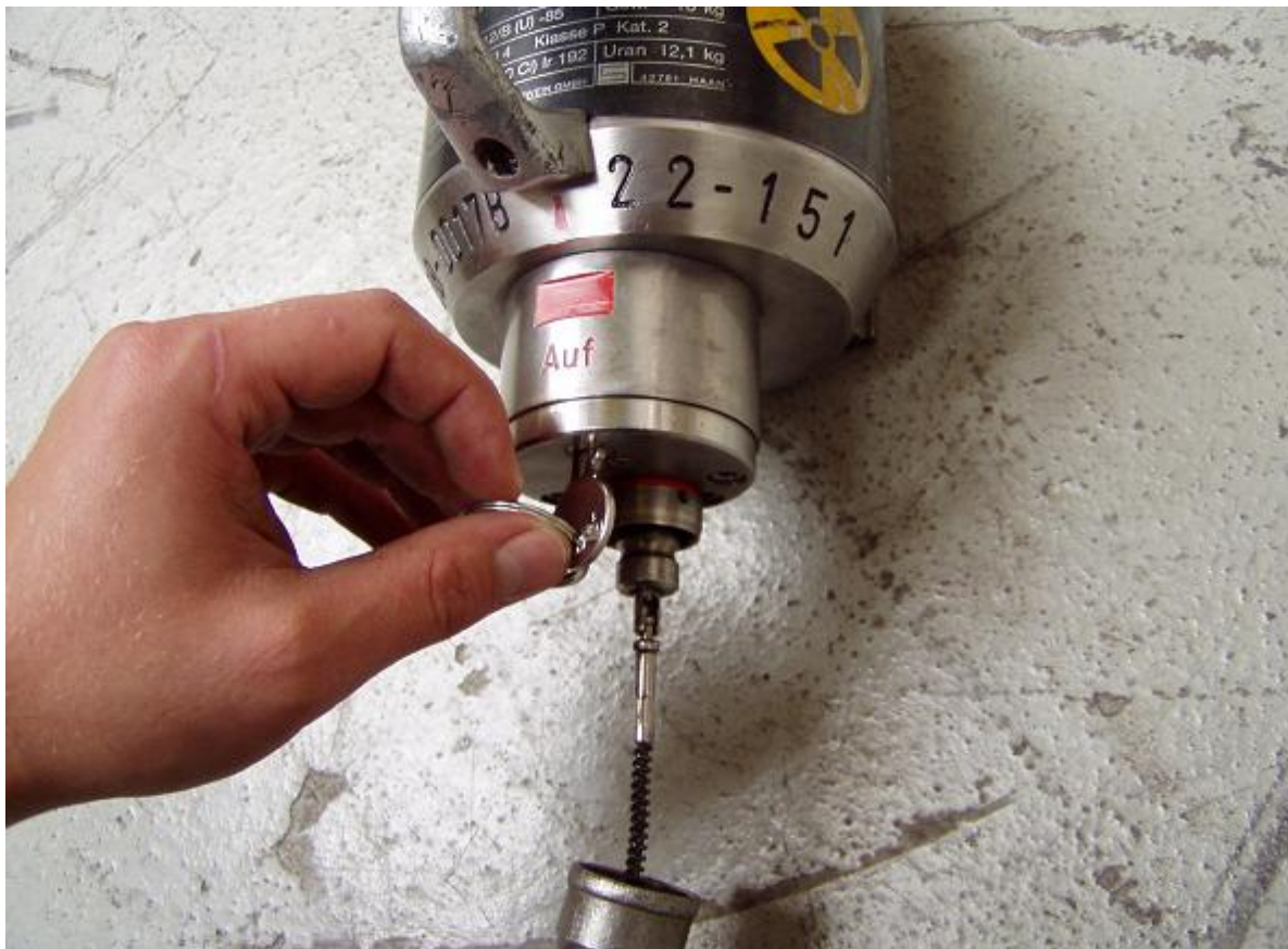
Obr. č. 18 - Spojení zářiče
