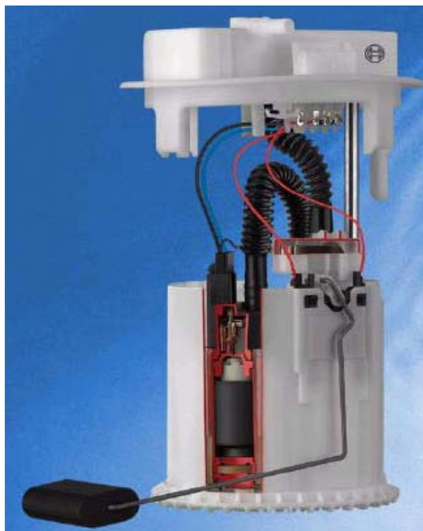
Obrázek 1 - Fotografie čerpadlového modulu v částečném řezu
