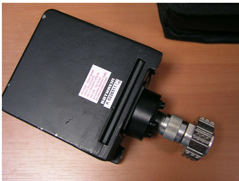
Obrázek č. 22 – Ukázka zatěžovacího odporu
