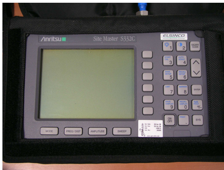
Obrázek č. 18 – Přístroj pro měření koaxiálních kabelů Site Master S332C Anritsu.
