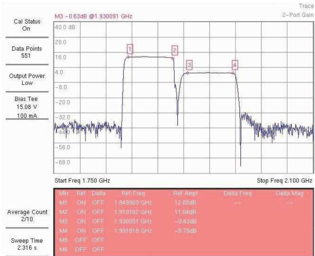
Obrázek č. 16 - 2-portové měření na TMA
