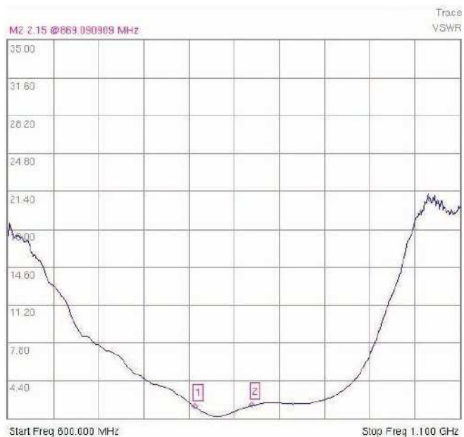
Obrázek č.5 - Zobrazení poměru stojatých vln
