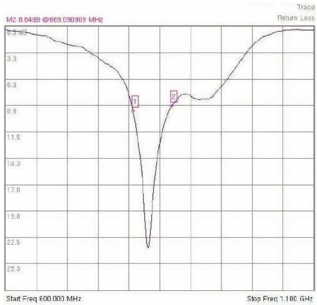
Obrázek č.4 - Průběh měření útlumu zpětného odrazu
