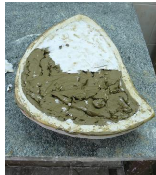
Obr. č. 5: Forma s modelem
