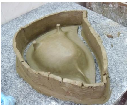
Obr. č. 3: Hliněná ohrádka
