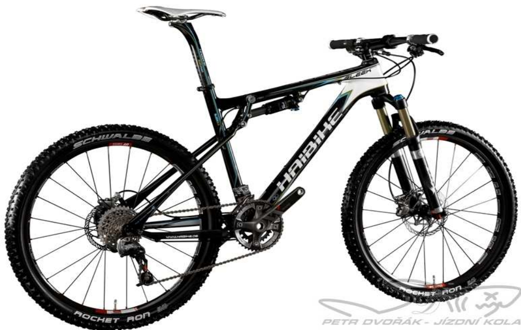
Obr. 3 Vrchol vývoje horského kola. Rám High Modulus UD Carbon, 4-klobová zadní nástavba, Superlight, přední vidlice a zadní tlumič Fox 32 RLC Fit lockout, 100mm, obě uzamykatelné za jízdy, komponenty Sram XX, karbonové zapletené kola DT Swiss XCR 1350 Carbon. Hmotnost 9,2 kg. Cena 160 000 korun ( www.velo-dvorak.cz/haibike ).
