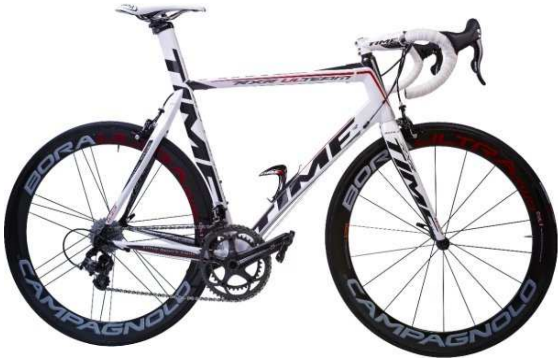
Obr. 4. Vrchol silniční nabídky, Time RXXR Ulteam, rám HM Carbon s Vibraser technology, vybavení Campagnolo record 2 x 11, zapletená kola Campagnolo Bora Ultra Two. Váha 6,6kg. Cena 250 000 korun ( www.time-sport.com ).
