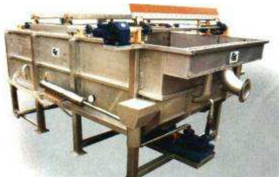
Obr. 4: Flotační jednotka (odpovídá schématu) (Hlavínek a kol., 2006)
