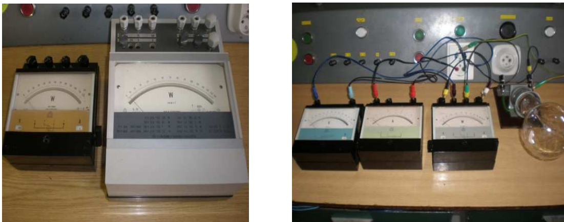
obr. 15 Analogové wattmetry, zapojení napětí, proudu a činného výkonu
