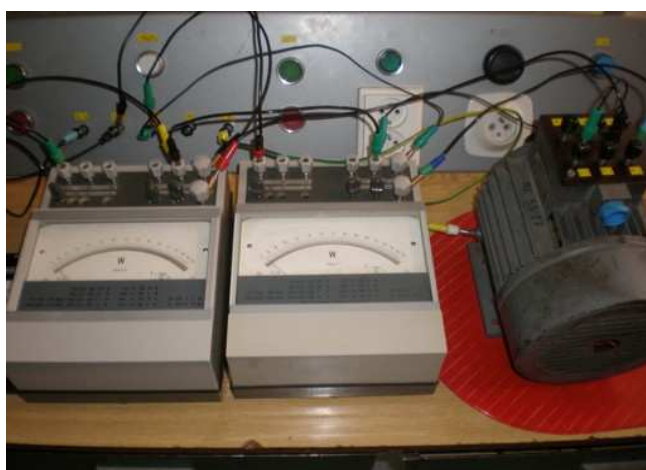
obr. 18 Měření výkonu pomocí dvou wattmetrů (Aronovo zapojení)
