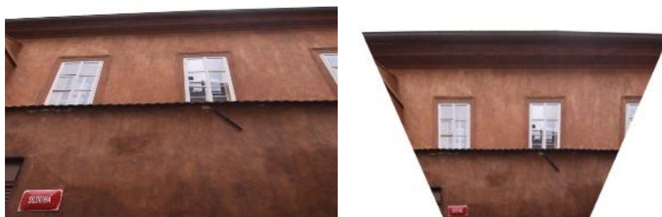
Obrázek 3a - Fotografie budovy před úpravou perspektivy, Obrázek 3b - Fotografie po úpravě perspektivy
