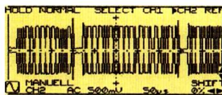
Obr. 89: CAN-Bitparáda a High- a Low-signály. High (vysoký)-signál kmitá mezi 2,5 V a 3,5 V. Kmitání Low (nízkého)-signálu se realizuje při hodnotách 1,5 V a 2,5 V.
