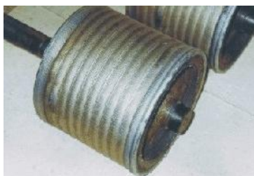
Obrázek č. 424a návar pomocí metody WIG/TIG
