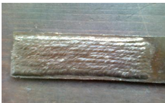
Obrázek č. 422a návar provedený ručně pomocí obalené elektrody
