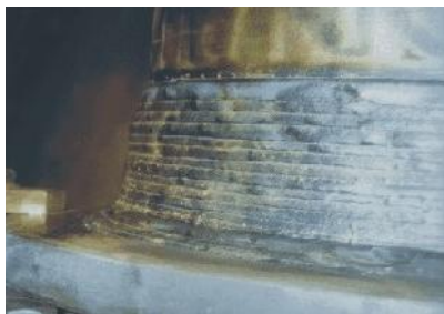
Obrázek č. 421a návar provedený metodou MIG
