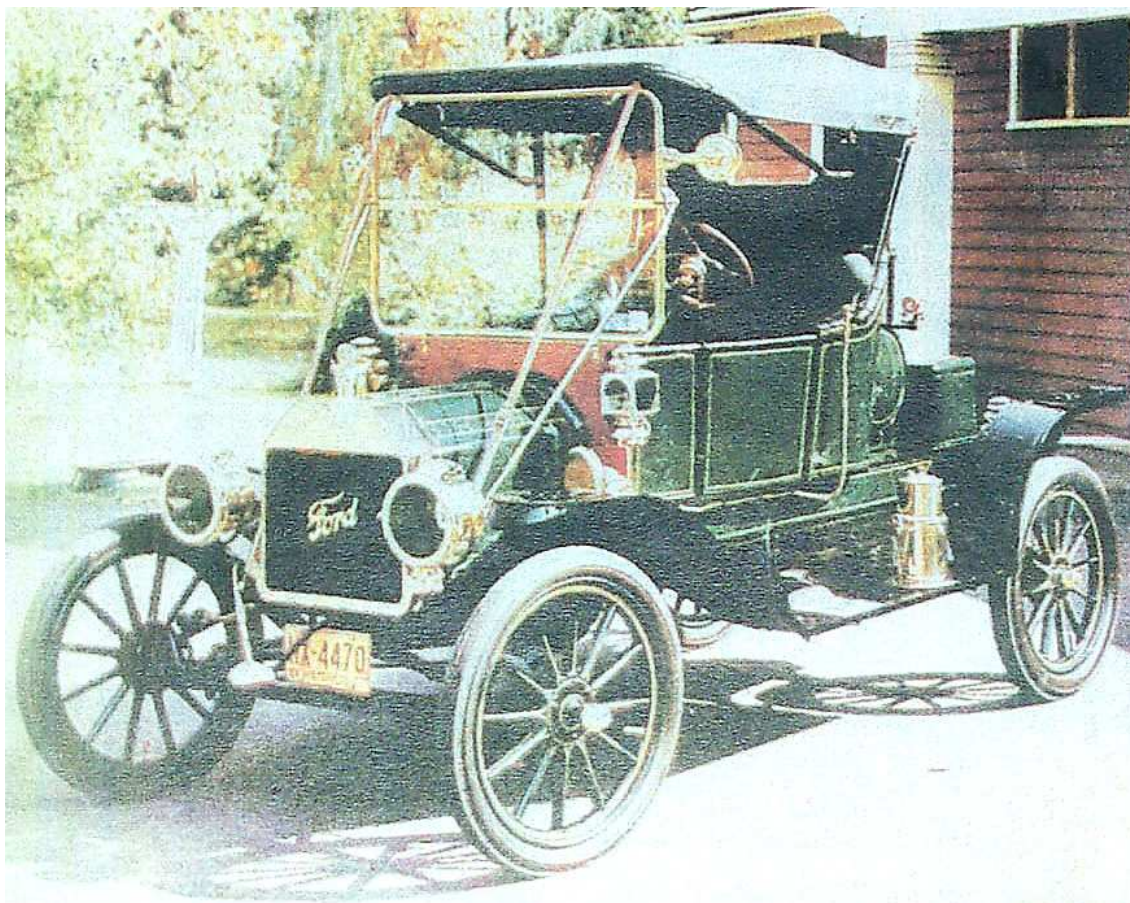
Obr. 8: Ford T - 1908 Výrobce: Ford Motor Co, Detroit, Michigan, USA. Nejúspěšnější Fordův typ – první automobil na světě vyráběný na běžícím pásu. Velmi robustní, přitom však pokroková konstrukce s rozsáhlým použitím kvalitních legovaných ocelí. (Minářík, 1980).
