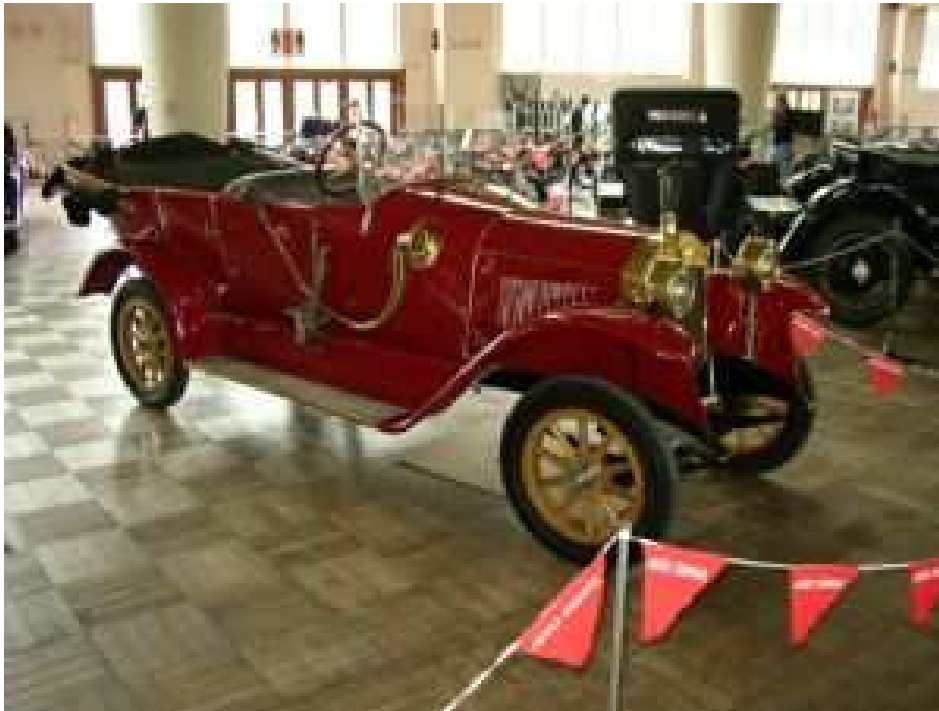
Obr. 10: Voituretta typ S objem válců 1771 ccm výkon 16 koní (Sivák, 2008).
