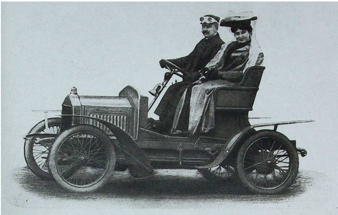
Obr. 9: Voituretta typu A s dvouválcovým motorem tvaru V – r. 1906 (Štechmiler a kol., 1957).
