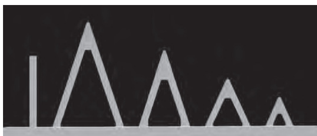
Obr. 36: Nitrid-křemíkové hroty připevněné k čipu [43]
