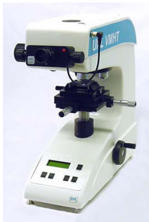
Obr. 51: Přístroj na měření mikrotvrlosti UHL VMHT
