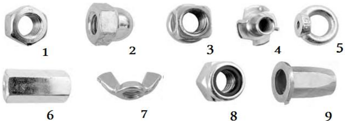
Obr. 10 Vybrané druhy matic: 1 – šestihránná, 2 – uzavřená, 3 – lešenová, 4 – narážecí, 5 – matice s okem, 6 – prodloužená, 7 – křídlatá, 8 – matice samojistná, 9 - nýtovací
