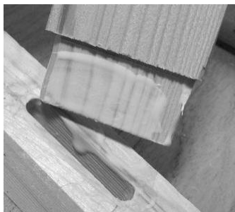
Obr. 20 Lepidlo aplikované na čep před složením.
