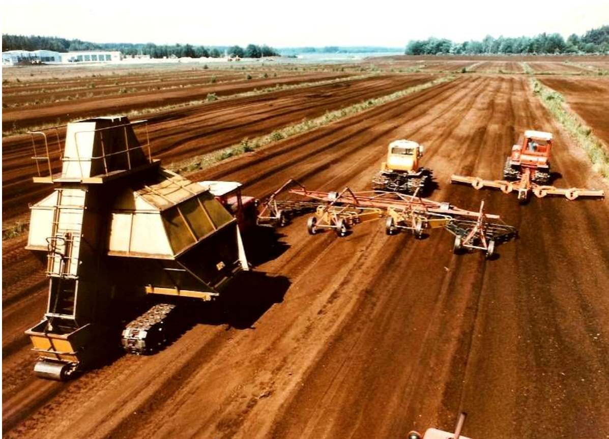
Foto 1: Frézování, řádkování a sklízení rašeliny (zdroj: archiv J. Matoušek)
