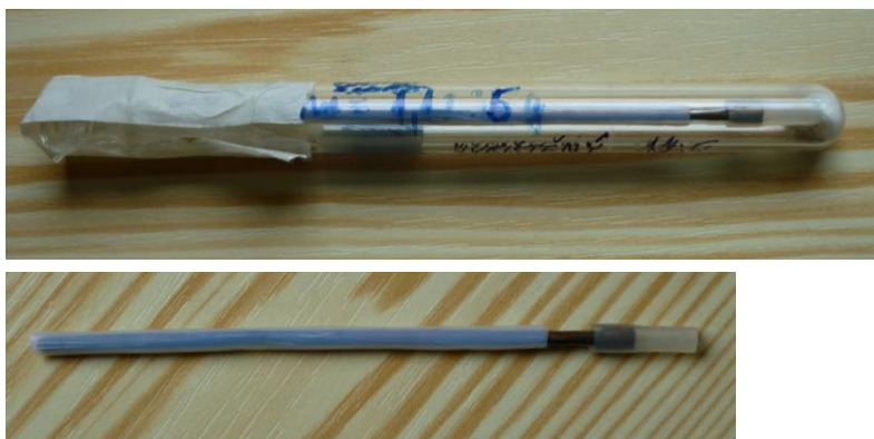
Obrázek č. 18 a č. 19: Amalgamátor v přepravní zkumavce (nahore) a v teflonovém obalu (dole) (foto: Aleš Pospíchal).
