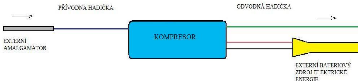
Obrázek č. 16: Schéma zapojení externího amalgamátoru (obrázek: Aleš Pospíchal).
