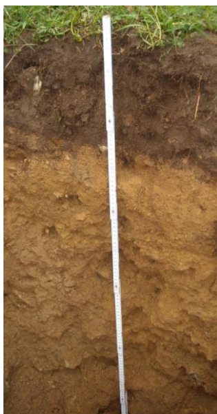
Obrázek č. 8: Půdní sonda 2 - kambizem modální (foto: Ľubica Pospíšilová).
