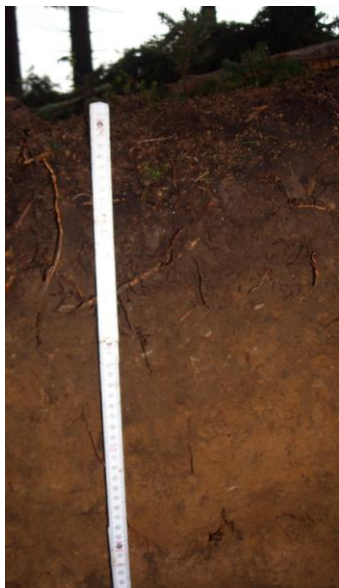
Obrázek č. 11: Půdní sonda 4 - kambizem modální (foto: Ľubica Pospíšilová).
