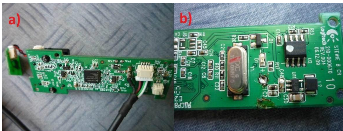
Obr. č. 17 a) Náhled DPS webové kamery Logitech 9000 Pro s připojeným hlavním datovým kabelem USB; b) Detail DPS webové kamery Logitech 9000 Pro s odpájeným stínícím vodičem (spodní strana DPS)
