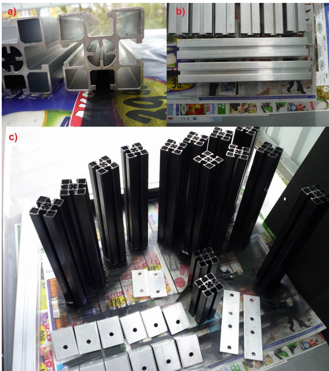
Obr. č. 1 a) Profil konstrukčních tyčí; b) Pohled na profilované montážní úchyty konstrukčních tyčí; c) Finální sestava konstrukčních tyčí s naneseným matným černým nátěrem včetně klínů a spojek
