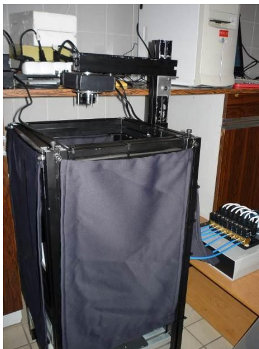
Obr. č. 9 Boční pohled na finální konstrukci přístroje pro sledování a vyhodnocování pohybové aktivity hmyzu (vpravo v záběru patrný také dávkovač vzduchu)
