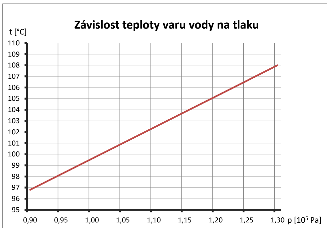
Obrázek 5: Graf závislosti teploty varu na tlaku
