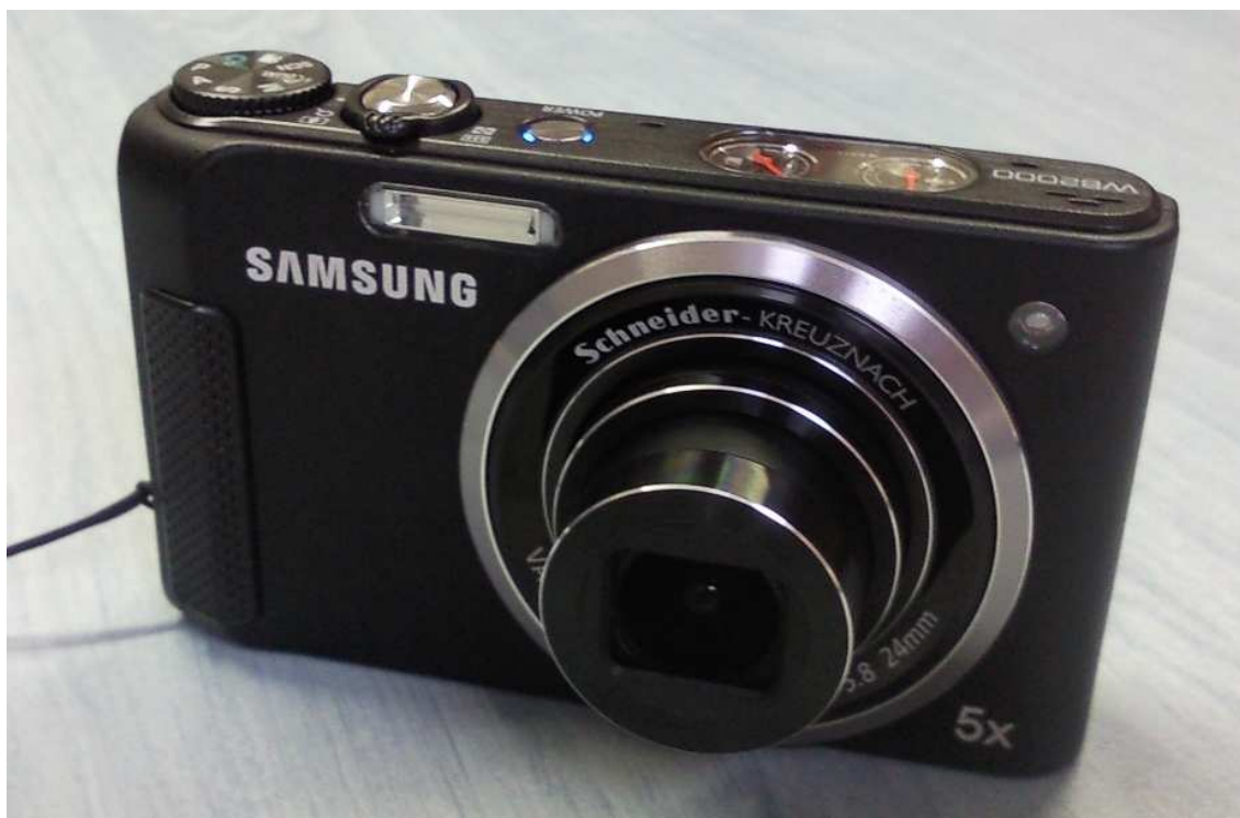
Obr. 3.7. – Digitální fotoaparát Samsung WB-2000 s možností vysokorychlostního snímání až 1000 snímků za sekundu
