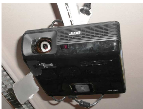
Obr. 2.7. – Dataprojektor zavěšený pod stropem „nohama vzhůru“, promítaný obraz otáčí elektronika dataprojektoru.
