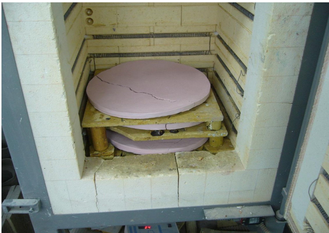
Obr. č. 18: Naložená pec červenou glazurou
