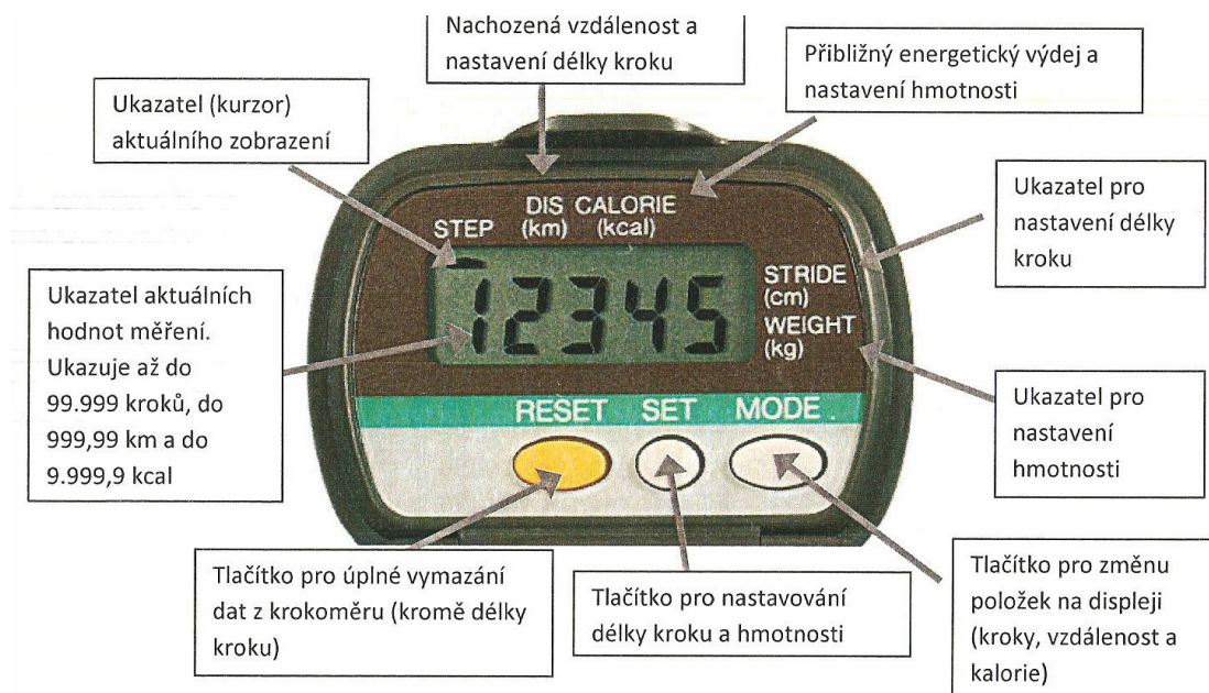
Obrázek 5: Popis displeje krokoměru Yamax SW-700
