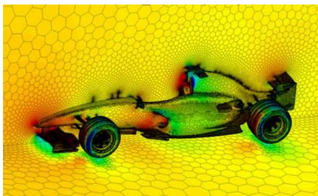
Obr 10.2: Síť z mnohostěnů a rozložení tlaků na formuli F1. [41]
