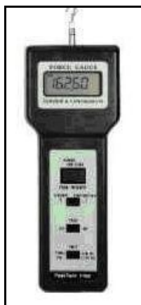
Obr. č. 12: Digitální siloměr, převzato a upraveno dle [6]
