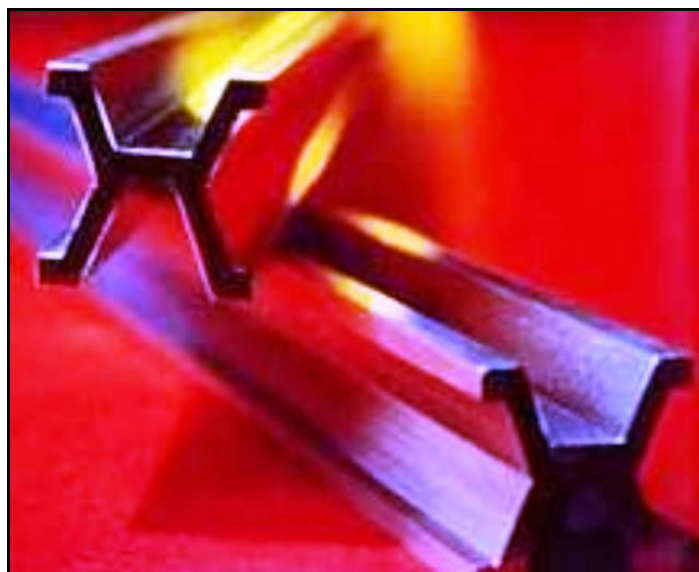
Obr. č. 1: Platino-iridiový etalon délky (1 m), převzato a upraveno z [5]
