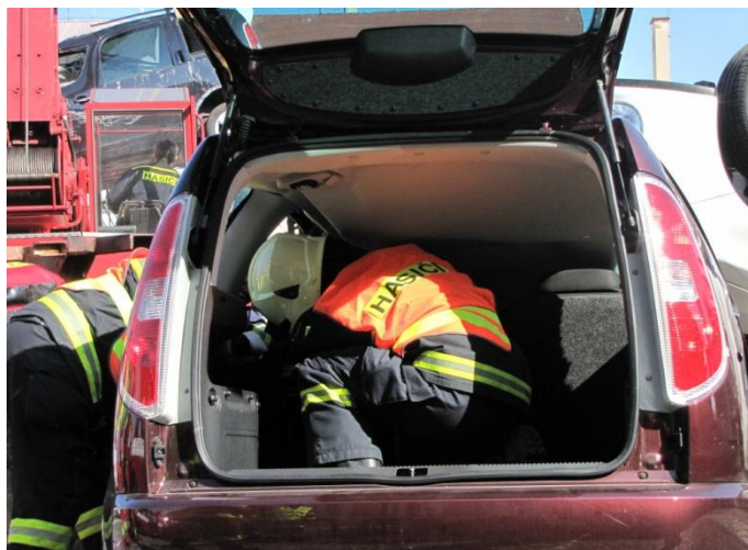
Obrázek 9: Přístupová cesta pátými dveřmi (vyproštění bez způsobení škody na vozidle)
