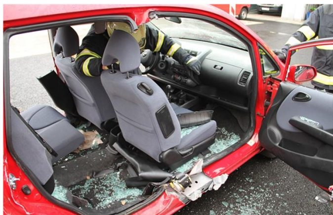
Obrázek 11: Vytvoření přístupové cesty z boku vozidla
