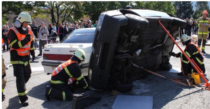
Obrázek 8: Stabilizace vozidla na boku
