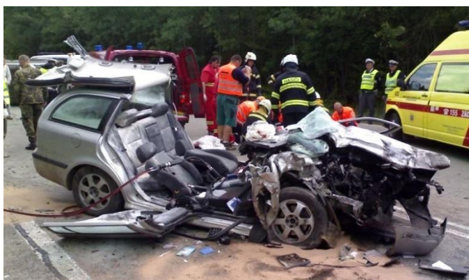
Obrázek 12: Vytvoření přístupové cesty odstraněním střechy vozu
