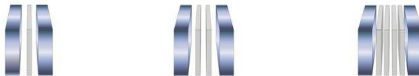
Obr. č. 6: Příklady složení bezpečnostního skla STRATOBEL. Zdroj: http://stavba.tzb-info.cz/okna-dvere/7969-vrstvene-bezpecnostni-sklo-v-otvorovych-vyplnich
