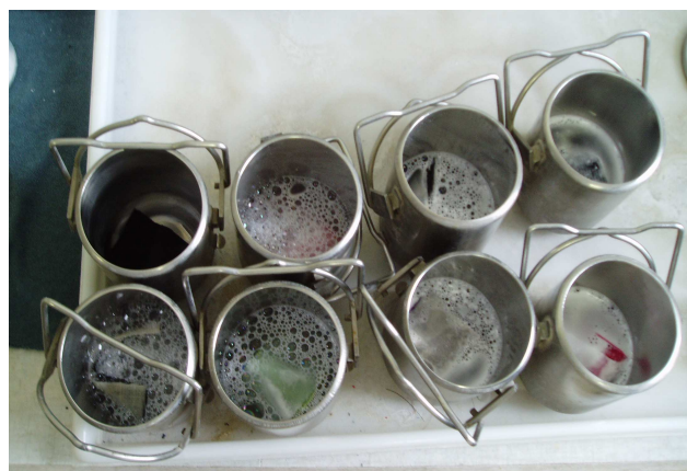
Obr. č. 79 Baňky se vzorky a prací lázní[79]
