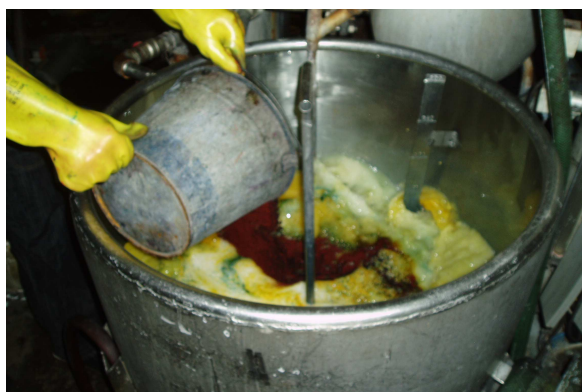
Obr. 52 Vysypání barviva do kotlíku [52]
