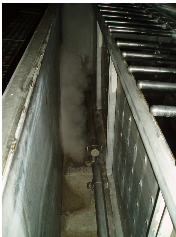
Obr. č. 63 Pouštění páry do lázně [63]
