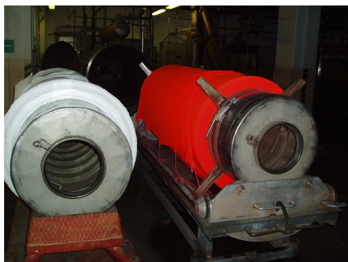
Obr. č. 58 Perforovaný válec s návinem [58]
