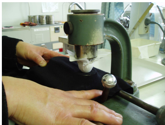
Obr. č. 87 Zkouška v otěru[87]
