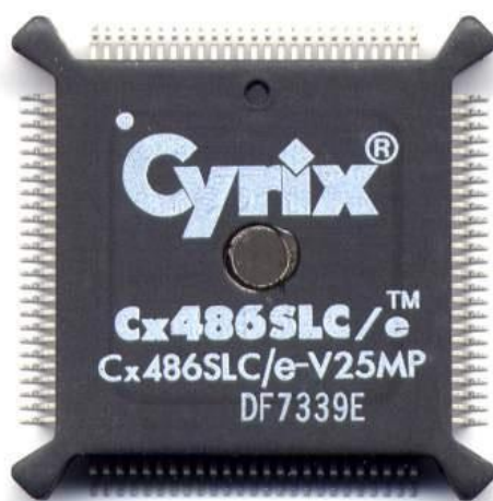
Obrázek 9: Pouzdro BQFP s nálitky v rozích; převzato z [4]
