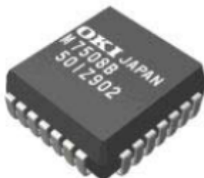
Obrázek 4: Páskové vývody tvaru "J"; převzato z [2]
