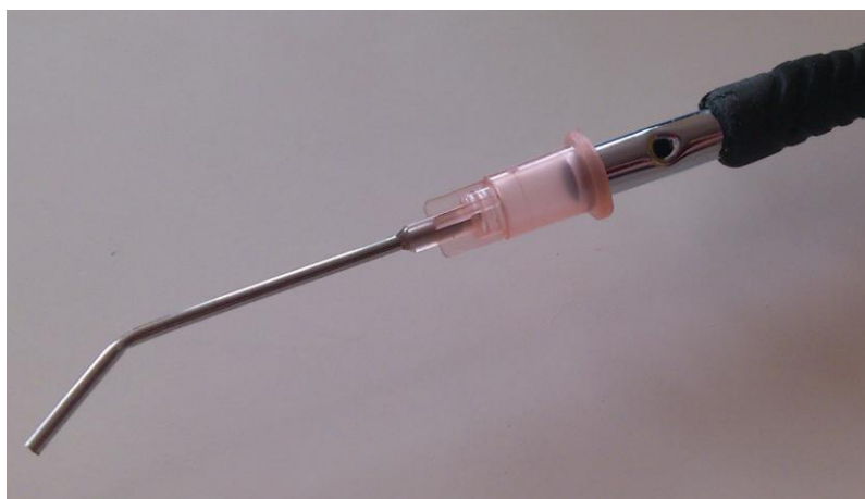
Obrázek 21: Ovládání podtlaku s nástavcem o průměru 1,2 mm
